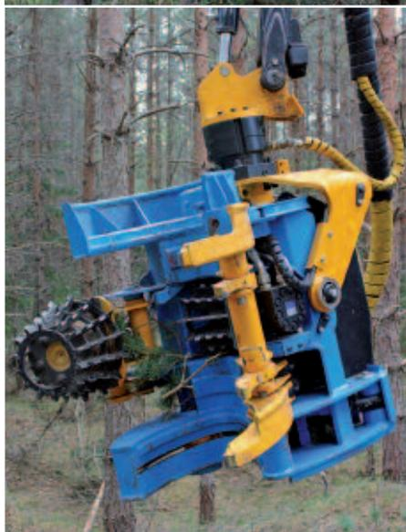
*Besonderheiten des Modells „255 Bioharvester“ von Allan Bruks sind die Zuführwalzen mit Längenmessung sowie Klingen zur Entastung und Teiltrindung.*
