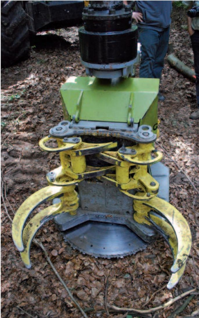
Beim Modell C 16.b von Bracke ist die Sägekette auf einer sich drehenden Scheibe fest montiert.
