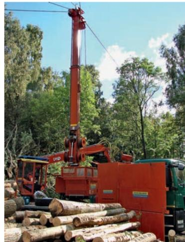
Abbildung 13: Seilkran „MM-Syncrofalke-U 4-t mit Laufwagen MM-Sherpa-U 4t XL“ (Foto Nemestothy)
