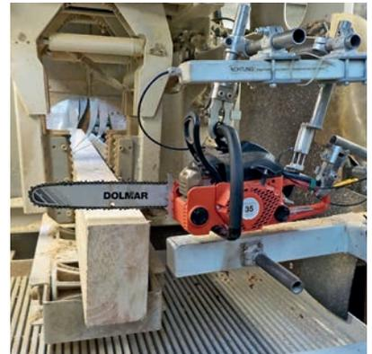
Dauerlaufprüfstand mit Konstruktionsvollholz
