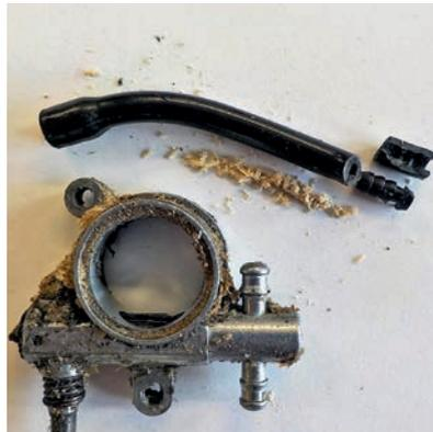
Defekte Ölpumpe mit verstopfter Schmierölleitung
