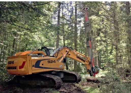
Abbildung 5: Einsatz Endmastbagger als Endbaustütze (Bild: FMB Schrofel)
