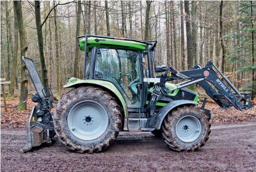
Abbildung 10: Forstraktor „Deutz 5090/5110 mit Forstausrüstung Ritter“ (Foto Weise)
