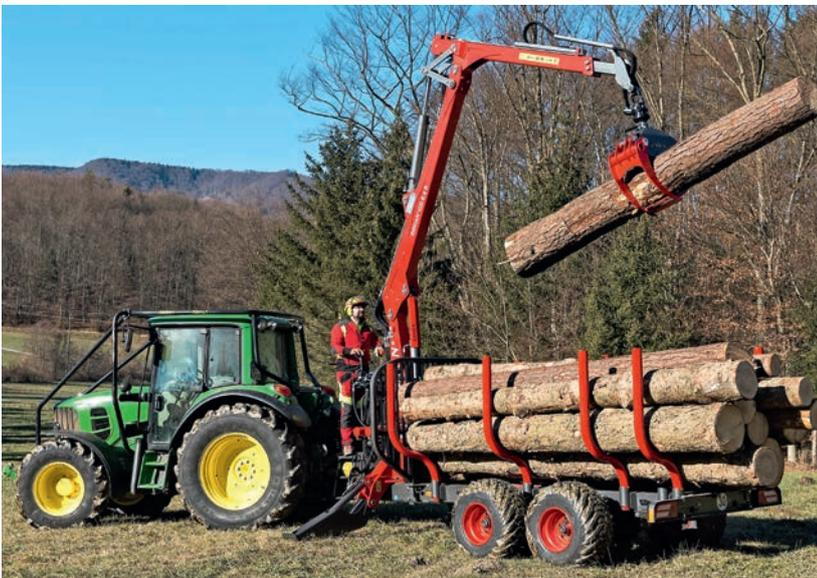
Abbildung 11: Rückeanhänger „Krpan Typ 8“ (Werkbild Krpan)
