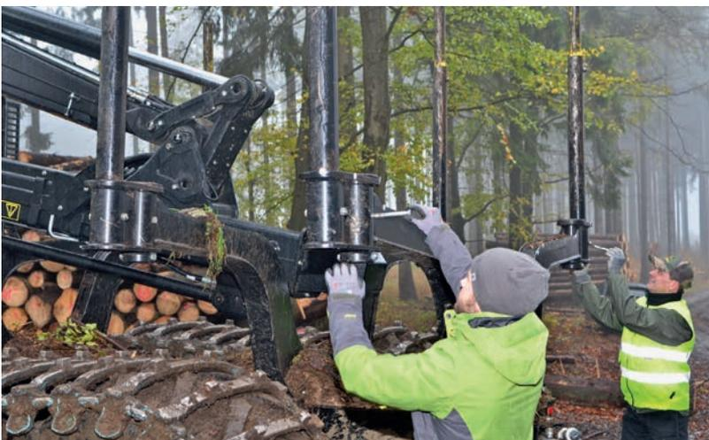
Abbildung 4: Umstecken der Breitenverstell-
