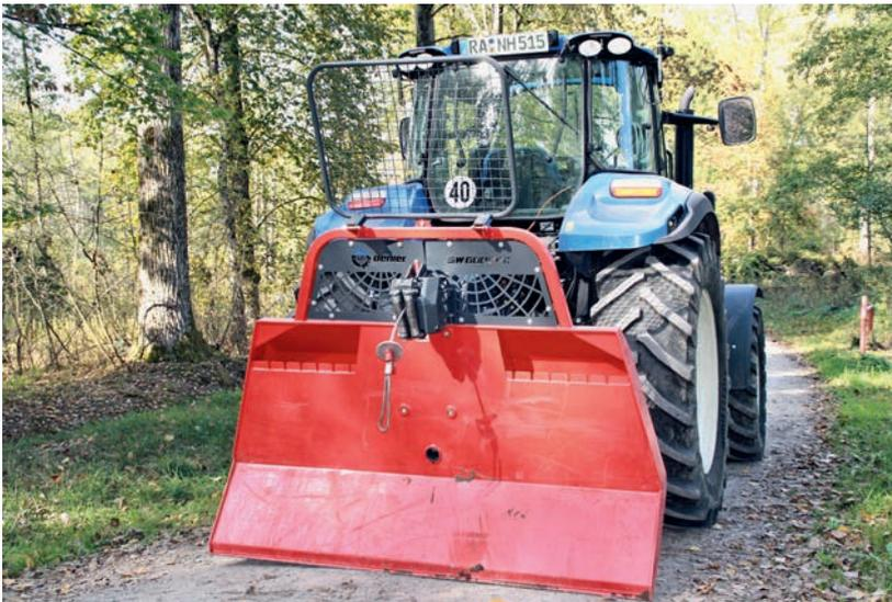
Abbildung 12: Anbau-Seilwinden „Oehler SW 6500P GT/SW 8500P GT“ (Werkbild Oehler)
