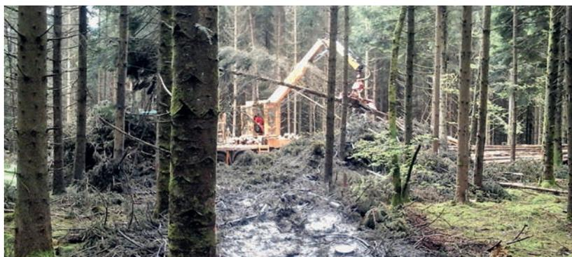
Abbildung 6: Einsatz des Gebirgsharvesters auf einer extremen Nassfläche im Jahr 2015 – Sturmholz. Die Vorkonzentration erfolgte mit der Kleinraupe. Das Holz konnte vor dem Käferflug aufgearbeitet werden. (Bild: FMB St. Peter)
