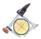
Bei der Messung muss die Kluppe soweit wie möglich über dem Stamm gefahren werden, dies verhindert das die Messung nur mit den Kluppenspitzen durchgeführt wird. Der Anpressdruck der Kluppenschenkel sollte möglichst bei allen Messungen gleich sein.
