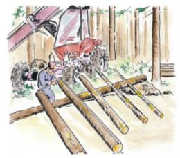
Das Maßband wird in dem vom des Vermessungssystem vorgeben Stamm eingehängt. Es werden dann die Messungen wie vom Kluppenmenü vorgeben, durchgeführt. Dies sind mehrere
