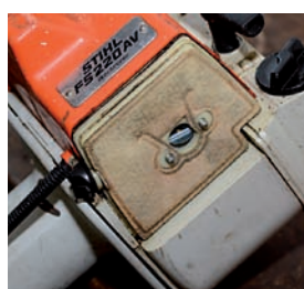
Auch die Demontage des Luftfilters ist rasch erledigt (unten von links). Je nach Einsatzstunden sollte das Vlies des Filters regelmäßig mit einer fettlösenden Lauge gereinigt werden.
