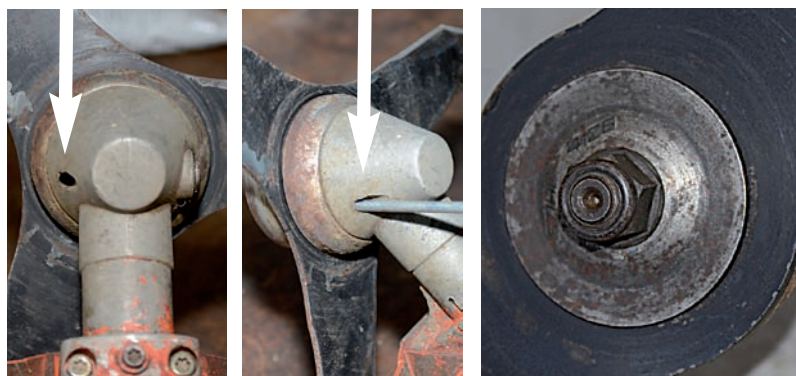
Arretierung eines Schneidkopfes: Um das Werkzeug nachzuschärfen, muß der Schneidkopf mit Hilfe eines Arretierungsstiftes (Pfeile) abgeschraubt werden. Die selbstsichernde Mutter an der Unterseite (rechts) ist mit einem Linksgewinde ausgestattet. Beim erneuten Montieren des Blattes muß daher auf die Drehrichtung geachtet werden. Außerdem wird eine neue Sicherungsmutter benötigt, da diese nur zum einmaligen Gebrauch bestimmt ist.
