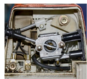
Auch die Demontage des Luftfilters ist rasch erledigt (unten von links). Je nach Einsatzstunden sollte das Vlies des Filters regelmäßig mit einer fettlösenden Lauge gereinigt werden.
