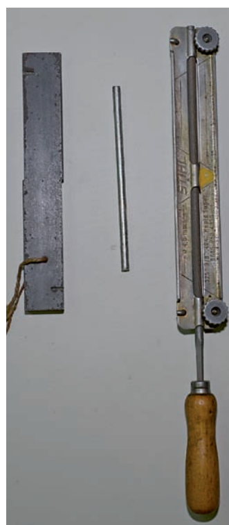
Werkzeuge zur Schneidkopfpflege (von links): Schränkwerkzeug, Arretierungsstift und Feile mit Führungsschiene und einem Durchmesser von etwa 5,5 Millimeter.
