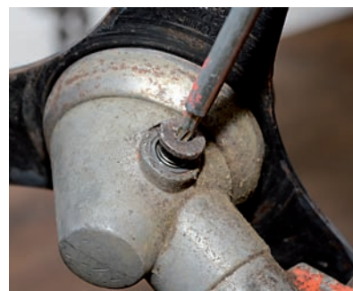
Das Winkelgetriebe der meisten Freischneider muß regelmäßig gefettet werden (oben). Eine Sichtkontrolle der Zündkerze (links) ist ebenfalls schnell erledigt. Links eine neue Kerze, in der Mitte eine Kerze mit rehbrauem „Gesicht“ zwischen Bügel und Elektrode, rechts eine durch mangelhafte Benzinverbrennung geschwärzte Kerze.
