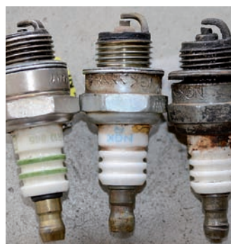
Das Winkelgetriebe der meisten Freischneider muß regelmäßig gefettet werden (oben). Eine Sichtkontrolle der Zündkerze (links) ist ebenfalls schnell erledigt. Links eine neue Kerze, in der Mitte eine Kerze mit rehbrauem „Gesicht“ zwischen Bügel und Elektrode, rechts eine durch mangelhafte Benzinverbrennung geschwärzte Kerze.
