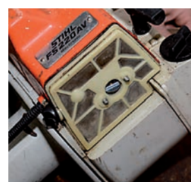
Auch die Demontage des Luftfilters ist rasch erledigt (unten von links). Je nach Einsatzstunden sollte das Vlies des Filters regelmäßig mit einer fettlösenden Lauge gereinigt werden.
