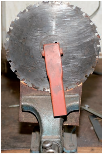
Um ein Kreissägeblatt im Schraubstock einzuspannen (links), sollte es auf einer Holzscheibe befestigt werden. Dann werden beide Seiten nacheinander geschärft. Der Schärfwinkel beträgt bei einem Meißelzahnblatt etwa 15 Grad, die Feile wird ungefähr fünf Grad nach oben geführt.
