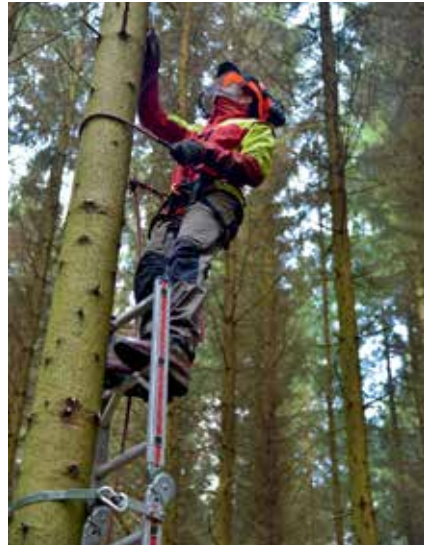
Arbeiten Sie sich immer bis zur letzten Sprosse der Leiter vor. Darauf ist das Leitersystem abgestimmt.
