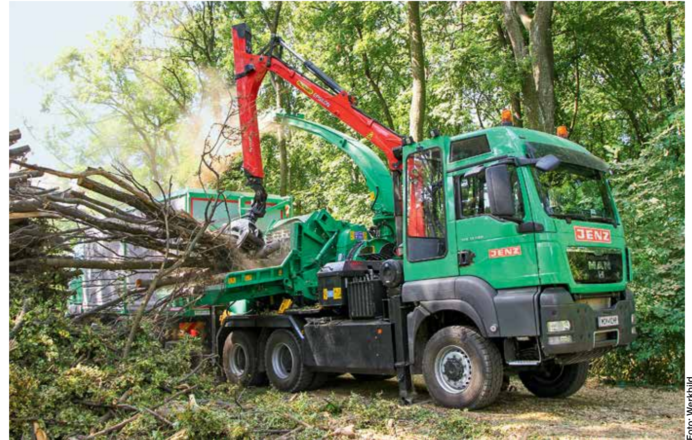
Starkes Holz, perfekter Polter, reibungslose An- und Abfahrt der Transporter: So lässt sich der Hacker am besten auslasten.
